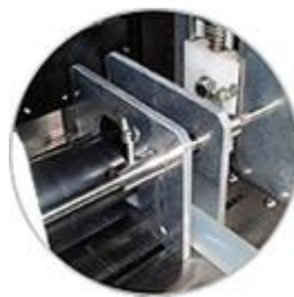
材料径(幅)に合わせ 調整の出来るサイドガイド
