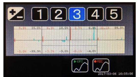
数字をタップするだけで、5段階の公差を選択可能。最新30本の圧力データを基準に、適正な公差の推奨値を自動表示します。
